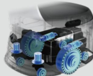
Intern entwickeltes Sechsrad-Fahrwerk mit Bewegungssteuerungsalgorithmen, verhindert Verschütten selbst bei einem Abstand von 1 cm
